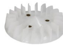
Ventilátor chladiča Ventilátor chladenia motora pre 2T motory, vonkajší priemer: 118mm, šírka: 25mm, rozteč montážneho otvoru: 44mm
